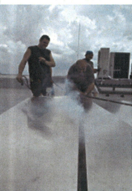
Těsnost odvětrávacích světlíků byla ověřena zadýmením funkčních spár. Negativní průnik dýmu dokumnetován z prostoru sálu 3NP a 4NP
