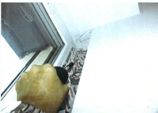
Těsnost odvětrávacích světlíků byla ověřena zadýmením funkčních spár. Negativní průnik dýmu dokumnetován z prostoru sálu 3NP a 4NP
