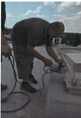
Těsnost odvětrávacích světlíků byla ověřena zadýmením funkčních spár. Negativní průnik dýmu dokumnetován z prostoru sálu 3NP a 4NP
